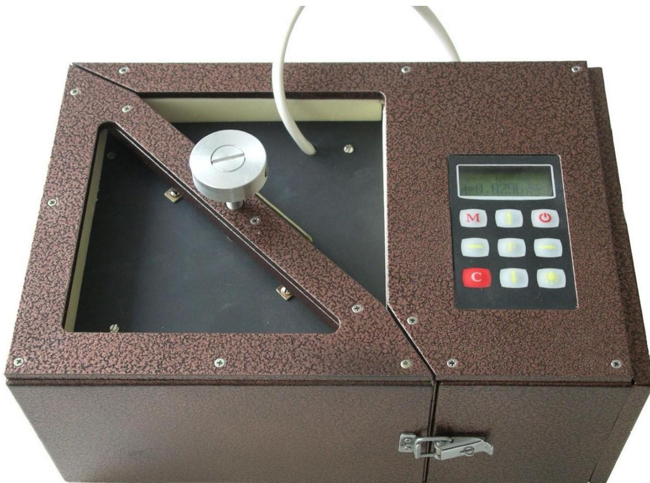
Рисунок 1 – Внешний вид измерителя теплопроводности ИТС-1
